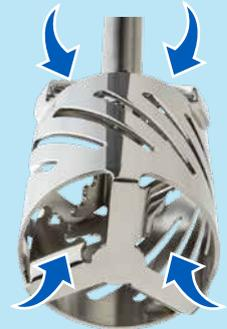
2. Les deux courants à haute vitesse et à contre-courant convergent à l'intérieur du stator, provoquant une forte turbulence et un cisaillement hydrodynamique, sans perte de vitesse due à des obstructions à l'intérieur du stator.
