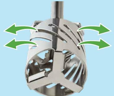
4. Der radiale Abfluss mit hoher Geschwindigkeit verbindet sich mit der langsamer fließenden Tankströmung und sorgt für zusätzliche hydrodynamische Scherung und Zirkulation.
