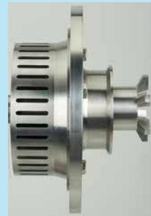
Die Radialstufe besteht aus einem radialen, durchflussstarken Rotor, der durch einen geschlitzten Stator entlädt, der zusätzliche mechanische und hydraulische Scherkräfte erzeugt. Durch die Zentrifugalkraft wird das Gemisch in dieser Phase von der Welle weg und entlang des Radius des Stators geschoben, so dass es mit hoher Geschwindigkeit an den
